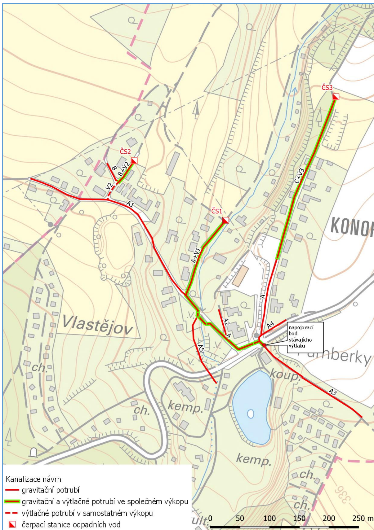
Obrázek 1 – Schématický zakres navrhované kanalizace Konopáč
